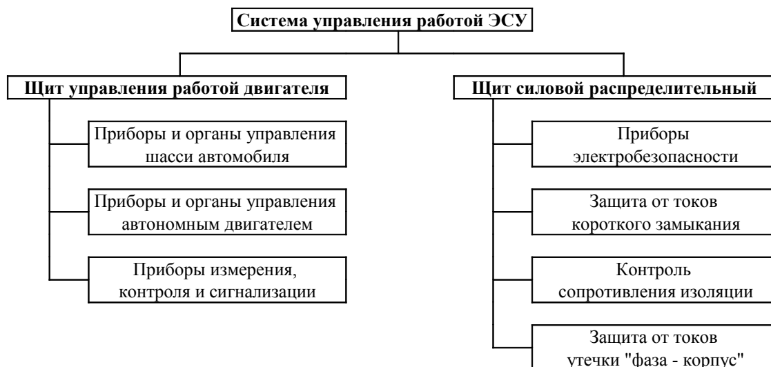
Рисунок 1. Структура системы управления работой ЭСУ автомобилей связи и освещения
